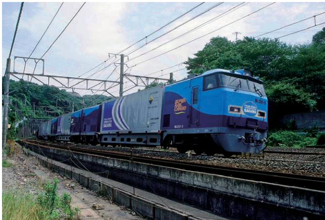
電車型特急コンテナ列車「スーパーレールカーゴ」
