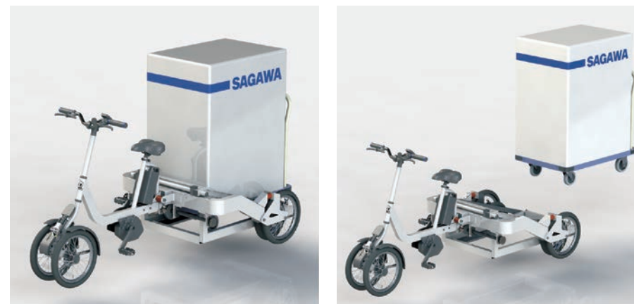
「TRIKE CARGO」牽引部分は台車を直接積載することができ、ワンタッチで着脱が可能（右図）
